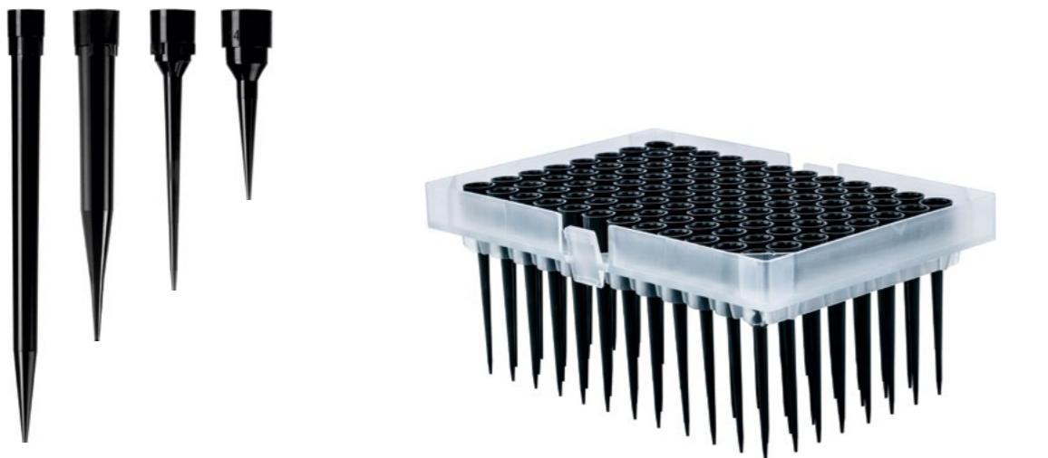
Mit blackKnights – den elektrisch leitfähigen Robotikspitzen von Ritter Medical – können auch kleinste Volumina präzise und kontaminationsfrei dosiert werden. Die Leitfähigkeit ermöglicht es, den Flüssigkeitsstand zu erkennen und nur soweit wie nötig in die Flüssigkeit einzutauchen, um ein sicheres Pipettieren und Dispensieren zu gewährleisten.
